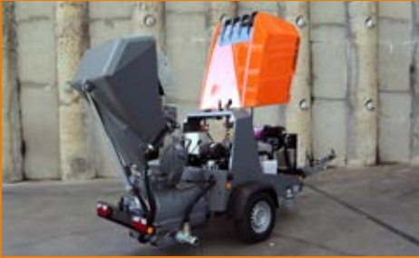
Yeni kaput konsepti ve çıkarılabilir arka kısım, tüm önemli servis ve bakım noktalarına kolay erişim sağlar.
